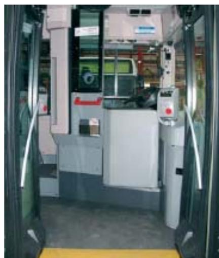
Un **troisième valideur sera spécialement implanté au niveau de la porte centrale**, à mi-hauteur, pour permettre les personnes en fauteuil roulant.
